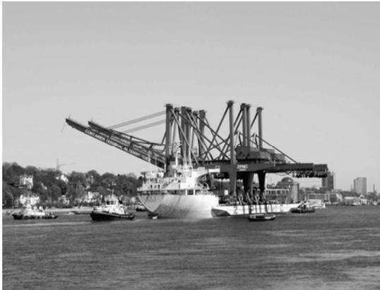
*Chinesisches Spezialschiff bringt neue Containerbrücken nach Hamburg*
